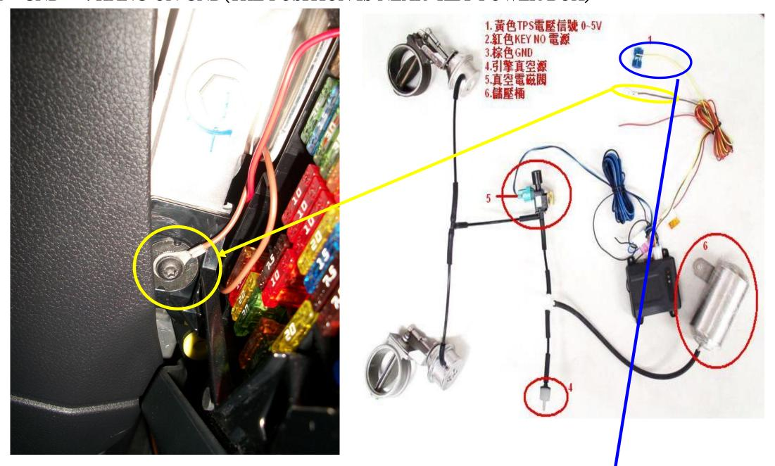
3 · PUT TPS 0~5V(YELLOW CABLE) AND OEM WIRE SIDE BY SIDE.
