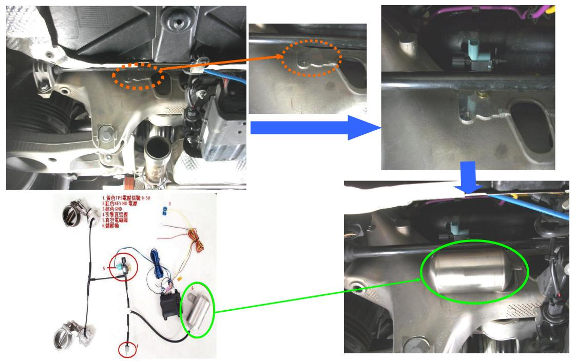
三、CONNECT VACUUM ELECTRIC VALVE、ONE WAY VALVE、VACUUM CANISTER(IF YOUR CAR HAS DIR SUSPENSION)
